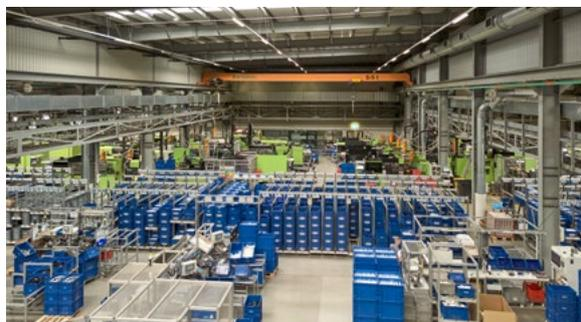
Im slowenischen Werk werden Aufputzpülkästen und Formstücke hergestellt und Füll- und Spülventile montiert.
