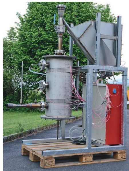
Der Holzvergasungsreaktor der zwei Absolventen. (Bild: ZHAW)
